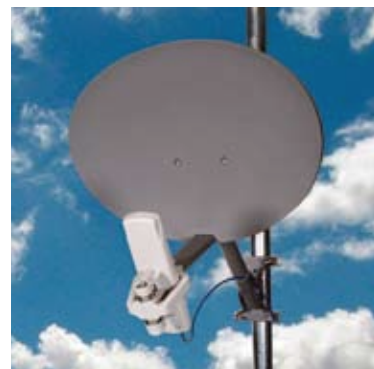
Backhaul con riflettore passivo
